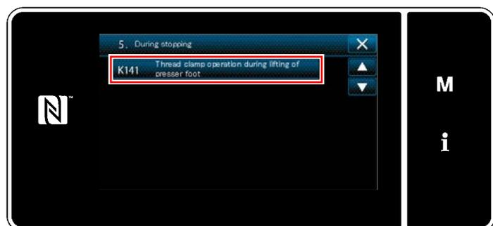
4) Appuyez sur "K141 Opération de serrage du fil lorsque le pied presseur est en position haute".
