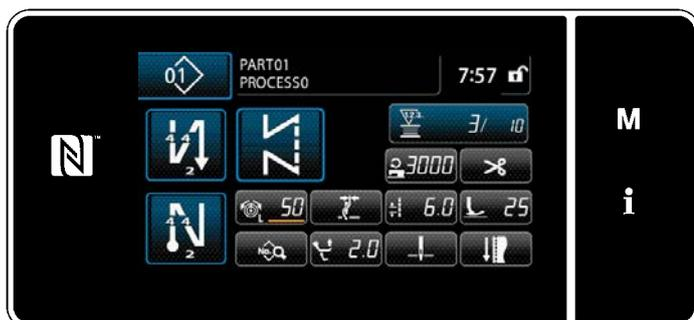
Wenn Sie beginnen, die Nadelfadenspannung entsprechend der Spulenfadenrestmenge zu korrigieren, erscheint eine Linie unter dem eingestellten Wert der Fadenspannungseinstelltaste.
