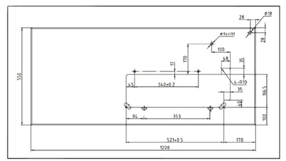
2.04 安装台板 Install the platen
