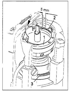
每天清洁旋梭,旋梭腔和齿轮3,如果持 续运行时,每天清洁多次。 Clean the hook ,hook compartment and toothed wheel 3 every day, several times if in continuous use. 关闭机器电源: 将针杆升到最高位置; 打开旋梭盖,取出梭壳和梭芯; 拧松内梭头舌1的螺钉; 转动手轮,直到梭壳2的尖端进入旋梭的 导槽内大约 5mm; 取出梭壳 2; 用石蜡清洁旋梭槽: 当放入梭壳2时,要确信梭壳2的凸出鼻 端部分啮合入针板的凹槽中; 拧紧内梭头舌1的螺钉并盖上旋梭盖。 Bring the needle bar to its highest position ;
