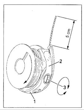
将梭芯装入梭壳1中; 将线穿过弹性压板2下的狭槽中; 将线穿过凹口处; 通过旋动螺钉3调节梭芯线张力。
