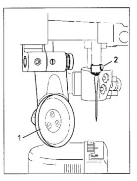
抬起滚轮压脚1并将其向外摆动; 松开螺钉2并插入机针,使机针的长槽背对着各自勾线的旋梭(即勾线旋梭在左, 长槽就向右;勾线旋梭在右,长槽就向左); 拧紧螺钉2并将滚轮压脚摆回到原位置。
