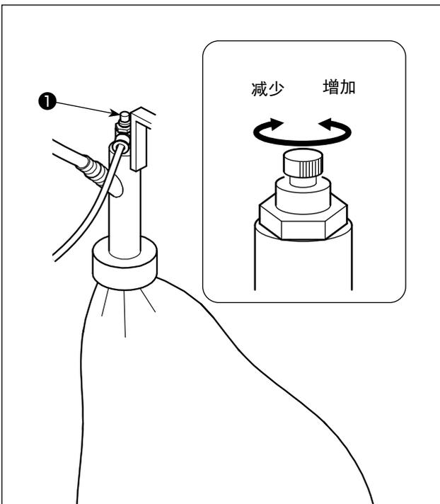
关于空气量的调节，旋转速度控制的旋钮**①**进行调节。如果朝顺时针方向旋转，流量会减少。如果朝逆时针方向旋转，流量会增加。
