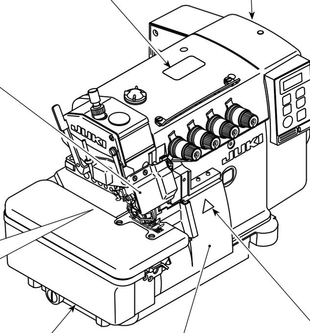
**Предостерегающая наклейка и наклейка с предупреждением о высоком напряжении**
