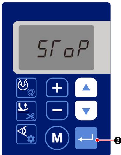
Quando si preme la parte posteriore del pedale durante la cucitura, la macchina per cucire si arresta e sul pannello operativo vengono visualizzati i caratteri [SToP]. (D), (E)
