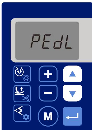
5. Lors de la mise sous tension de la machine à coudre alors que le mode entièrement automatique est sélectionné, « PEDL » s'affiche sur le panneau de commande, comme indiqué sur la figure de gauche.
