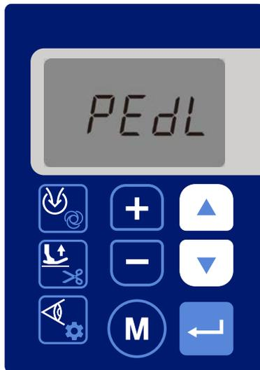
5. 选择全自动模式，并打开电源时，如图在面板上显示“PEDL”。如果希望开始缝制，应反踩一次踏板。
