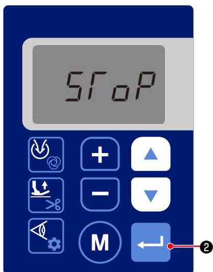
缝制过程中，如果向后踩踏板，缝纫机就会停止，面板显示【SToP】。Ⓓ、Ⓔ
