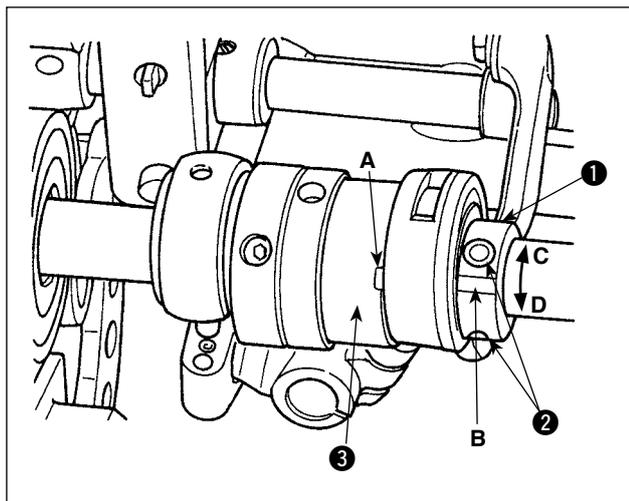
Le cran A de l'accouplement ③ s'aligne sur le cran B dans la came excentrique du dispositif de tirage lorsque le rouleau est placé sur la position standard. Pour régler la phase d'entraînement, desserrer les deux vis de fixation ② de la came excentrique du dispositif de tirage ①. Lorsqu'on déplace la came dans le sens C, le départ du rouleau est avancé. Lorsqu'on la déplace dans le sens D, le départ du rouleau est retardé.
