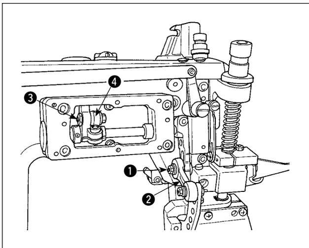
Desserrer la vis ❶ pour régler la distance d'entraînement du rouleau. La distance d'entraînement diminue lorsqu'on relève la biellette ❷. Elle augmente lorsqu'on abaisse la biellette ❷.
