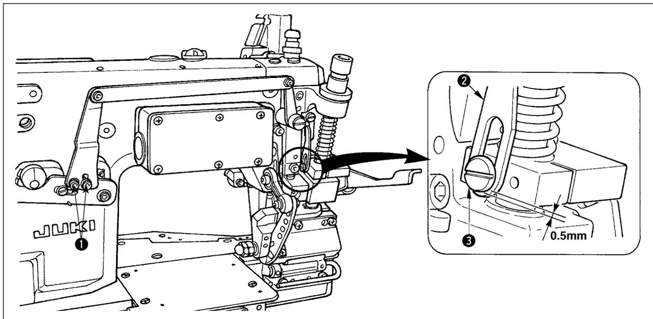
Régler avec les deux vis ❶ de façon que le jeu entre la biellette de levier de releveur de presseur (courte) ❷ et la vis de charnière ❸ soit de 0,5 mm lors du relevage du presseur avec le rouleau supérieur abaissé.
