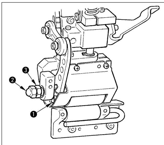
Régler le ressort de tension d'embrayage ❶ de façon qu'il n'y ait pas de dépassement du rouleau supérieur à grande vitesse. Pour augmenter la pression du ressort, desserrer l'écrou borgne ❷ et tourner l'écrou ❸ à droite (sens des aiguilles d'une montre). Pour diminuer la pression du ressort, tourner l'écrou ❸ à gauche (sens inverse des aiguilles d'une montre).
