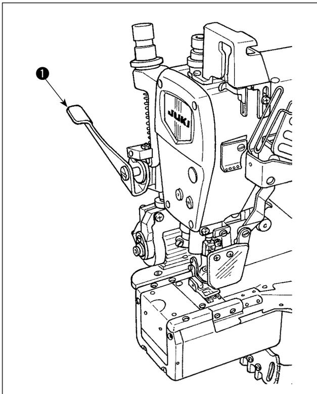
Relever le levier ❶ lorsque le dispositif de tirage du tissu n'est pas utilisé pour mettre le tissu en place ou le retirer après la couture.
