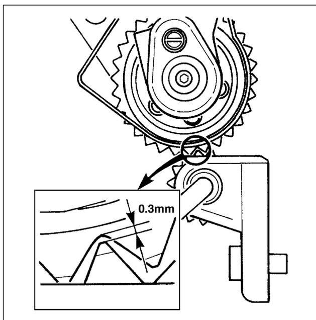
Dans le cas du rouleau à engrenage, desserrer l'écrou ② et régler la longueur de la vis ① de façon que le jeu entre les rouleaux supérieur et inférieur soit d'environ 0,3 mm lorsque les rouleaux sont abaissés.
