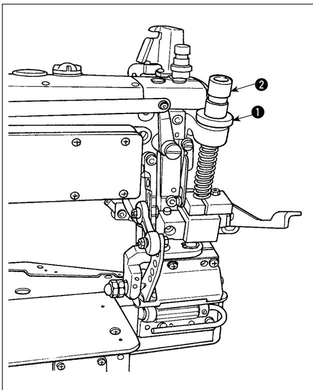
Pour augmenter la pression du presseur, desserrer l'écrou **1** et tourner le régulateur de ressort de presseur **2** vers la droite (sens des aiguilles d'une montre). Pour diminuer la pression du presseur, tourner le régulateur de ressort de presseur **2** vers la gauche (sens inverse des aiguilles d'une montre).
