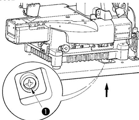
In caso della macchina per cucire nuova, sostituire l'olio lubrificante (JUKI GENUINE OIL 18) con quello nuovo dopo averla usata per un mese circa. Successivamente, provvedere a sostituire l'olio lubrificante ogni sei mesi.
