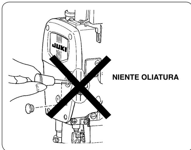
I meccanismi posti all'interno della struttura quali la barra dell'ago, l'alzapiedino ed i componenti dello stendifilo sono lubrificati con grasso. Non aggiungere mai l'olio all'interno della struttura.
