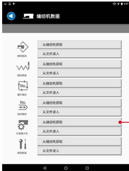
1) 向下按存储器开关的「从缝纫机获取」键①。
