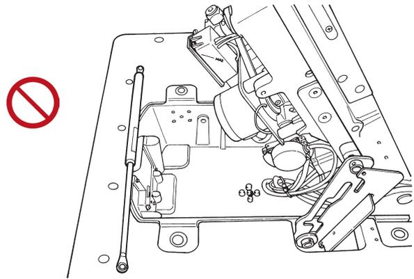
**Assicurarsi di controllare la funzione della molla a gas periodicamente.** Se il declino funzionale della molla a gas viene rilevato, assicurarsi di sostituirla con una normale prima di utilizzare la macchina per cucire.
