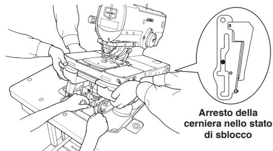
Arresto della cerniera nello stato di sblocco
