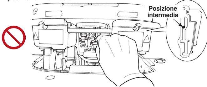
**Assicurarsi di sollevare la macchina per cucire** finché l'arresto della cerniera non sia bloccato nella **posizione di infilatura** per fissare la macchina per cucire.
