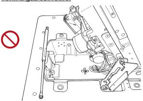
Veiller à vérifier régulièrement le fonctionnement du vérin à gaz. Si un dysfonctionnement est détecté, veiller à le remplacer par un vérin à gaz en bon état avant d'utiliser la tête de la machine.
