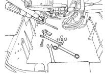
Veiller à s'assurer qu'il n'y a pas d'outil ou de pièce à l' intérieur du couvercle inférieur avant de ramener la tête de la machine en position fermée.
