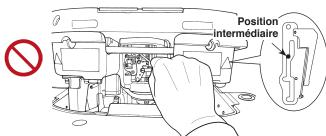
Afin de sécuriser la tête de la machine, veiller à l'ouvrir jusqu'à ce que la butée de charnière se verrouille en position d'
