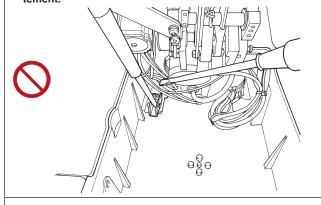
Ne jamais ramener la tête de la machine en position fermée avec un outil ou une pièce insérée dans le couvercle inférieur.
