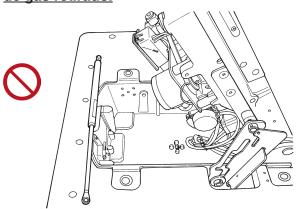
Asegúrese de comprobar la función del muelle de gas periódicamente. Si se detecta el deterioro funcional del muelle de gas, asegúrese de reemplazarlo con uno normal antes de utilizar la máquina de coser.
