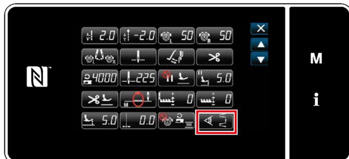
Le réglage activer/désactiver la détection du saut de points peut être défini modèle par modèle.
