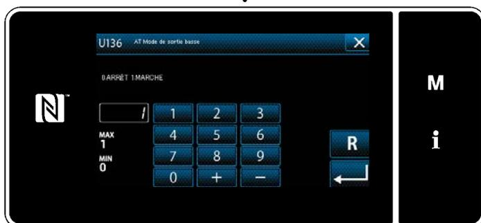
Si le commutateur à mémoire "U136 Mode de sortie faible AT" est réglé sur "Activer (valeur de réglage 1)", la tension du fil de l'aiguille peut être réglée avec précision en mode de sortie faible. Si vous souhaitez utiliser la machine à coudre dans la zone de tension de fil supérieure, régler U136 sur "Désactiver (valeur de réglage 0)". Dans ce cas, la tension du fil de l'aiguille peut être réglée sur une valeur de sortie plus élevée.
