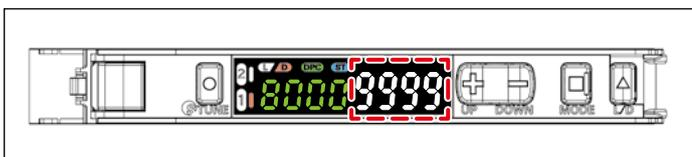
3. Heben Sie die Operationsplatte an, und verriegeln Sie den Rastbolzen. Prüfen Sie, ob die am Verstärker angezeigte Lichtmenge "9999" ist.
