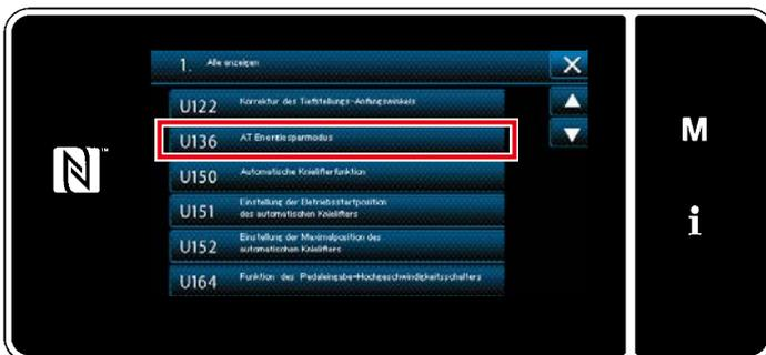
Wird der Speicherschalter "U136 AT-Niedrigleistungsmodus" auf "Aktivieren (Einstellwert 1)" gestellt, kann die Nadelfadenspannung im Niedrigleistungszustand fein eingestellt werden.
