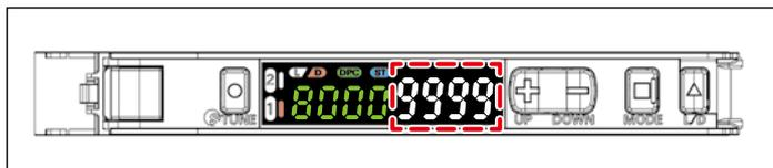
3. Sollevare la piastra operativa e bloccare lo spintore filettato. Verificare che la quantità di luce visualizzata sull'amplificatore sia "9999".
