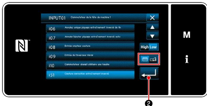
Si l'élément de fonction i51 ou plus est sélectionné, l'opération peut être effectuée si la pression sur le bouton est réglée.
