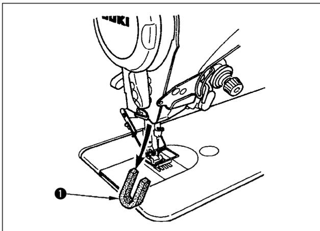
Retirer la pièce de fixation de barre à aiguille ❶ destinée au transport.
