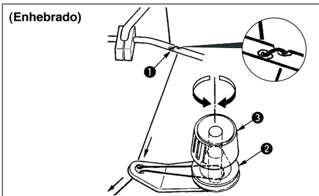
6) Si le bobinage du fil de canette sur la canette est irrégulier, desserrer l'écrou ④ et tourner le bloc-tension du fil de canette pour régler la hauteur du disque de tension du fil ②.
