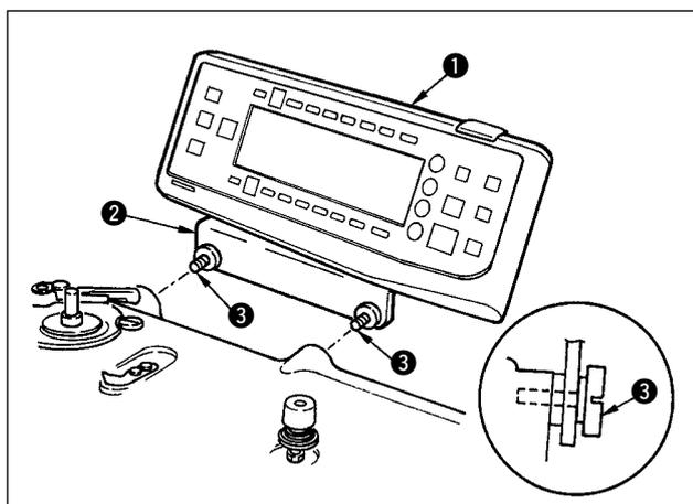
1) Installer le panneau de commande ❶ sur la tête de machine au moyen des vis ❸ qui ont été montées sur le support du panneau de commande ❷.
