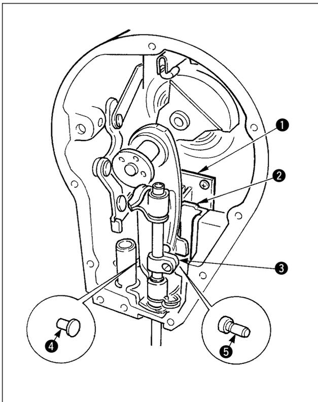
Appliquer périodiquement de la graisse spéciale (n° de pièce du tube de graisse : 40006323) fournie comme accessoire. (Il n'est pas nécessaire de remettre de la graisse lorsque la machine fonctionne dans des conditions normales. Remettre de la graisse lorsqu'elle fonctionne dans des conditions sévères.)
