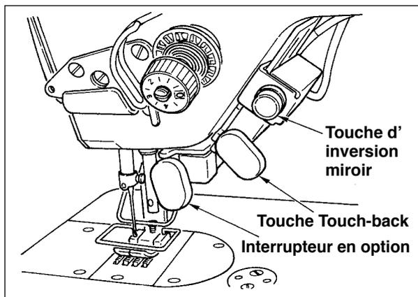
**B. Cas d'une machine sans levier de relevage de fil auxiliaire**
