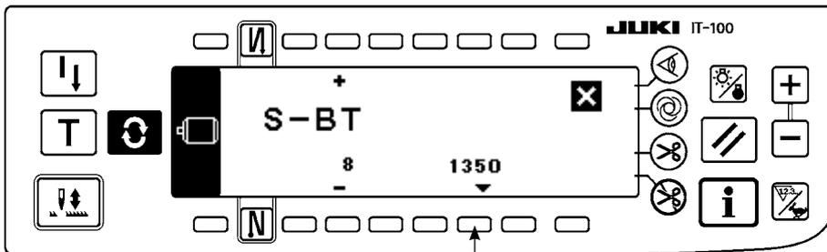
**Exemple) Changement de la vitesse d'exécution de points arrière (paramètre n° 8)**
