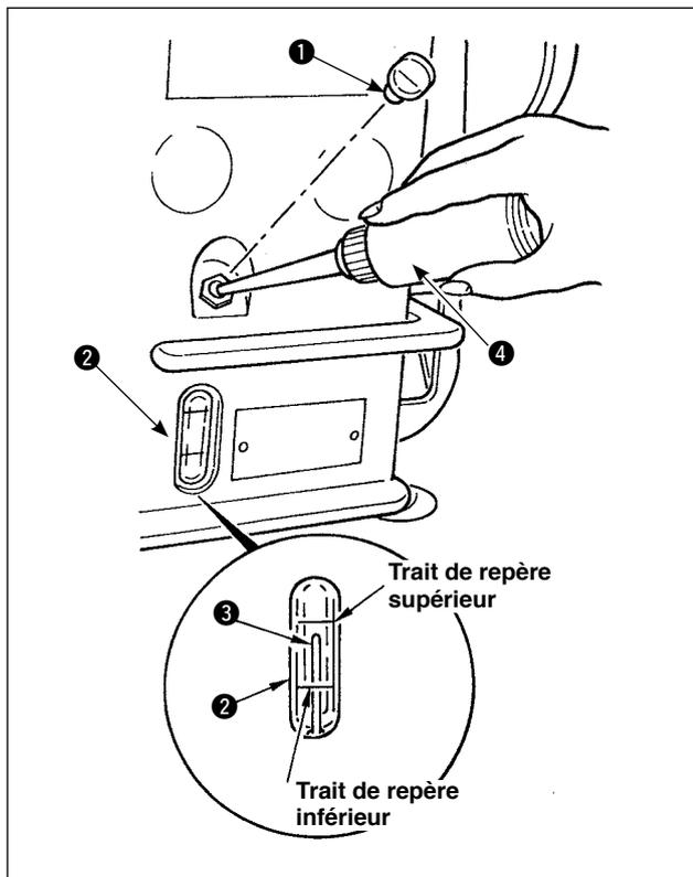
Avant d'utiliser la machine, remplir le réservoir d'huile avec de l'huile pour la lubrification du crochet.
