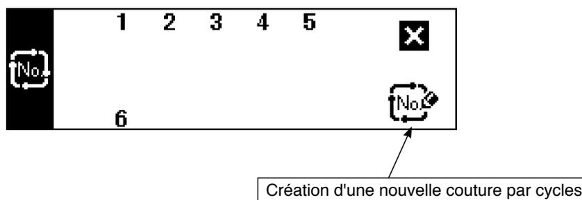
Le paramètre de verrouillage des touches a été réglé sur "1" en usine et les pictogrammes de création de nouvelle configuration ne sont pas affichés. Pour créer une nouvelle configuration dans un mode, mettre le paramètre de verrouillage des touches à "0". (Voir le second écran de saisie des données communes sous (1) Données de couture communes de 6-16. Informations.)
