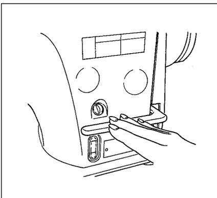
Lors d'une couture de condensation, le pas d'entraînement est réduit et des points d'attache sont exécutés lorsqu'on actionne le levier de commande d'entraînement arrière au début ou à la fin de la couture.
