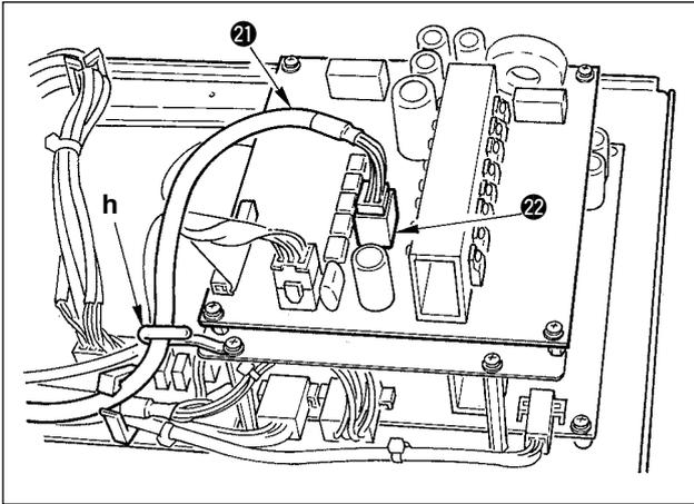
14) Introduire le cordon du connecteur carré noir à 8 broches 21 provenant de la tête de la machine dans la boîte électrique par l'orifice du couvercle avant B, le faire passer dans les attache-câbles "e", "f", "h" et "j", puis brancher le connecteur carré noir à 10 broches au connecteur CN72 22.
