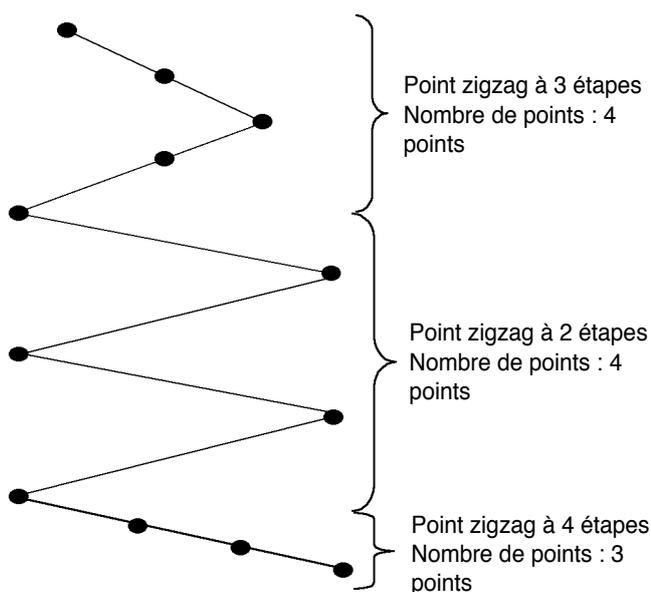
**Exemple) Pour créer les positions de pénétration de l'aiguille représentées sur la figure ci-dessous.**
