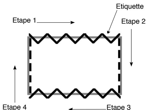
Exemple) Dans l'opération de pose d'étiquettes, sélectionner les configurations de zigzag de la couture à dimensions constantes au point zigzag à 2 étapes et au point zigzag droit comme sur la figure et exécuter la couture à dimensions constantes.
