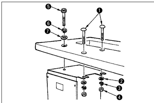
Poser la boîte électrique sur la face inférieure de la table sur la position indiquée sur la figure à l'aide du boulon à tête ronde ❶, de la rondelle plate ❷, de la rondelle Grower ❸ et de l'écrou ❹ fournis avec la machine ainsi que du boulon hexacave ❺, de la rondelle plate ❻ et de la rondelle Grower ❼ fournis avec la machine.
