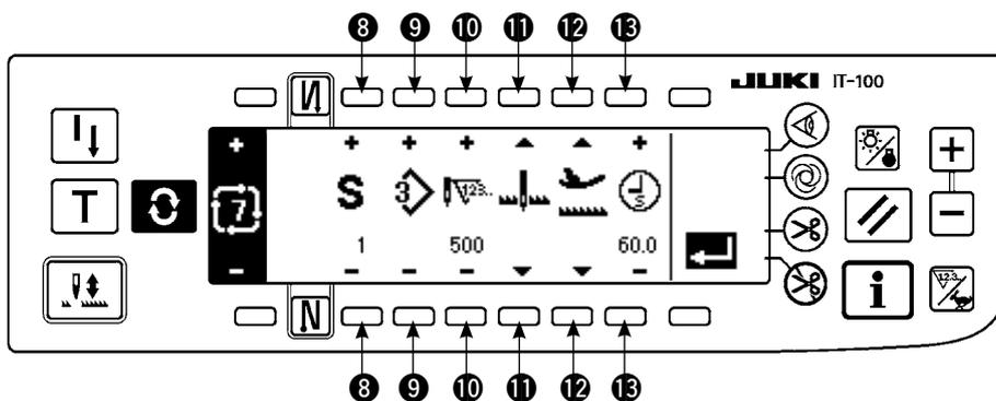
6) Spécifier le numéro de configuration, le nombre de points, la position d'arrêt et la position de presseur pour chaque étape à l'écran de modification de couture par cycles.
