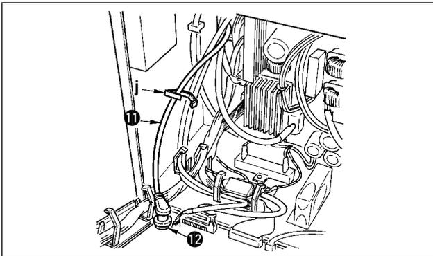
10) Introduire le cordon du connecteur rond gris à 7 broches 11 provenant de la tête de la machine dans la boîte électrique par l'orifice du couvercle avant B, le faire passer dans l'attache-câble "j", puis l'introduire dans le connecteur CN30 12.
