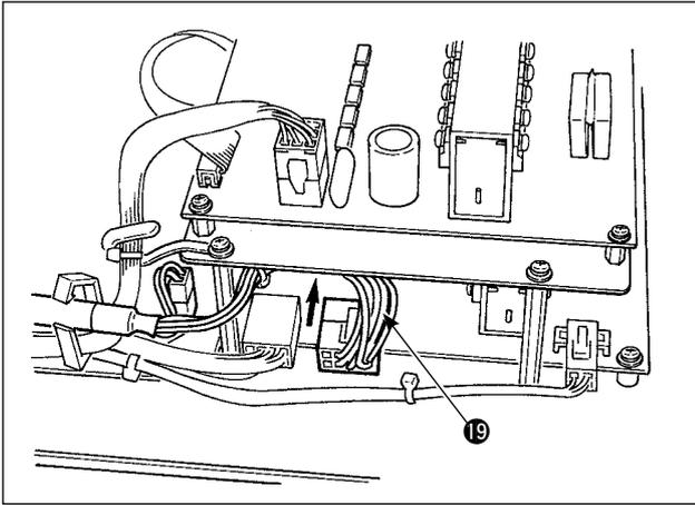
13)-2 Introduire le cordon du connecteur blanc à 10 broches 19 provenant de la tête de la machine à l'arrière du connecteur comme sur la figure.
