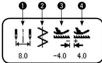
La valeur de limitation de la largeur maximale de zigzag, la référence de la ligne de base des points, la valeur de limitation du pas d'entraînement avant et la valeur de limitation du pas d'entraînement arrière s'affichent à la mise sous tension.
