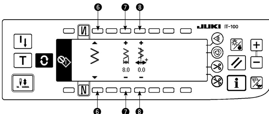
6) Pour revenir du mode de réglage du crochet au mode de couture normale, mettre la machine sous et hors tension.
