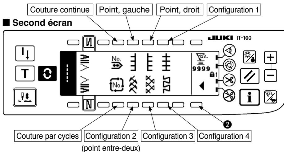
1) Sélectionner la configuration de zigzag que l'on désire exécuter avec le commutateur de sélection lorsque la figure ci-dessus est à l'écran. La configuration déterminée est affichée à la section A.
