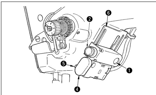
\* La position de l'interrupteur d'entraînement arrière **④** et de l'interrupteur d'inversion miroir **②** peut être inversée.
