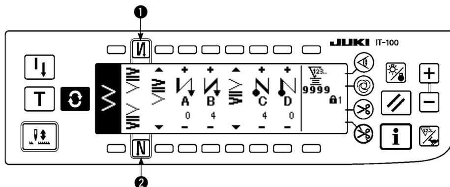
Pour l'exécution de points arrière, la condensation standard, la condensation à 2 positions et la condensation personnalisée sont disponibles.
