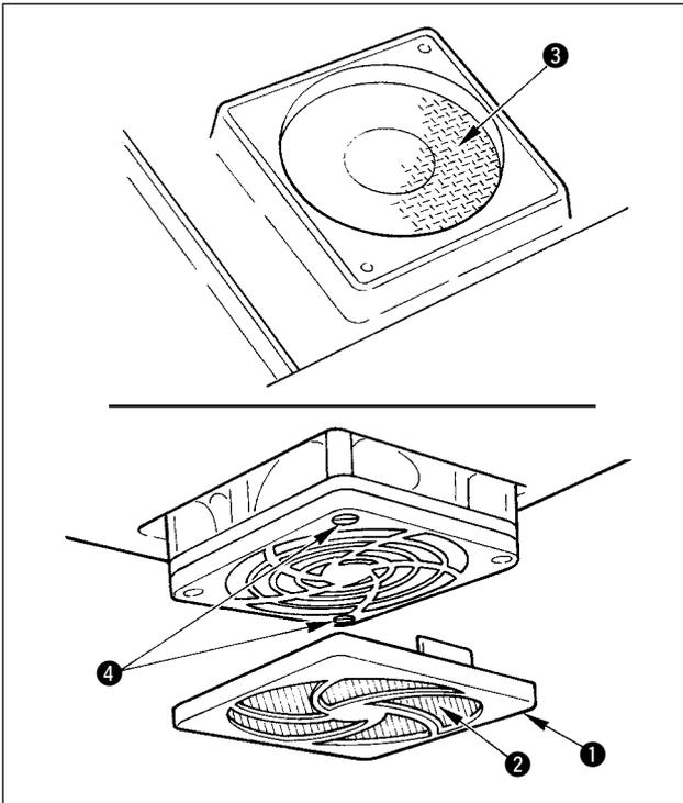
Des débris de tissu ou autres matières similaires s'accumulent autour du filtre du ventilateur de refroidissement installé à la partie inférieure du sous-couvercle et cette accumulation peut entraîner dans certains cas une diminution de l'effet de refroidissement de la tête de la machine.
