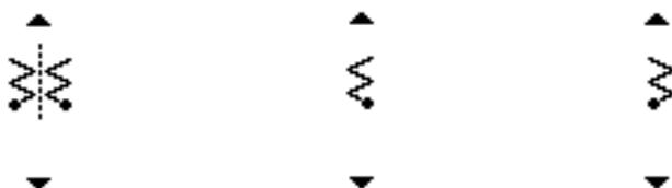
Position d'arrêt, optionnelle    Position d'arrêt, droite    Position d'arrêt, gauche
