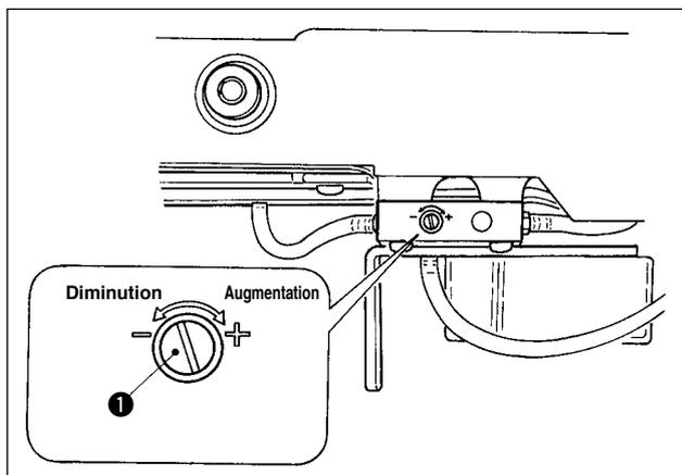
Le réglage de la quantité d'huile du crochet s'effectue avec la vis de réglage d'huile ❶.
