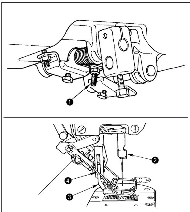
1) La hauteur de relevage standard du presseur avec la genouillère est de 10 mm.
