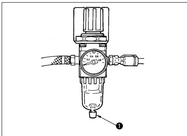
Lorsque le régulateur est plein d'eau, tourner le bouton de vidange **1** dans le sens inverse des aiguilles d'une montre.
