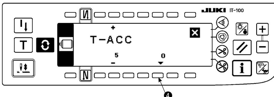
Changer le numéro de paramètre sur "5" avec la touche "+" de l'interrupteur **3** sur la figure ci-dessus.
