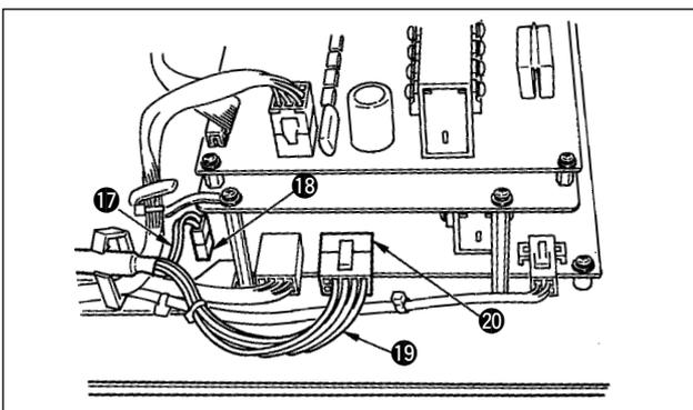
13)-1 Introduire le cordon du connecteur blanc à 10 broches 17 et le cordon du connecteur bleu à 2 broches 18 provenant de la tête de la machine dans la boîte électrique par l'orifice du couvercle avant B, les faire passer dans les attache-câbles "e", "f" et "j", puis introduire le cordon du connecteur blanc à 10 broches dans le connecteur CN51 19 et le cordon du connecteur bleu à 2 broches dans le connecteur CN46 20.
