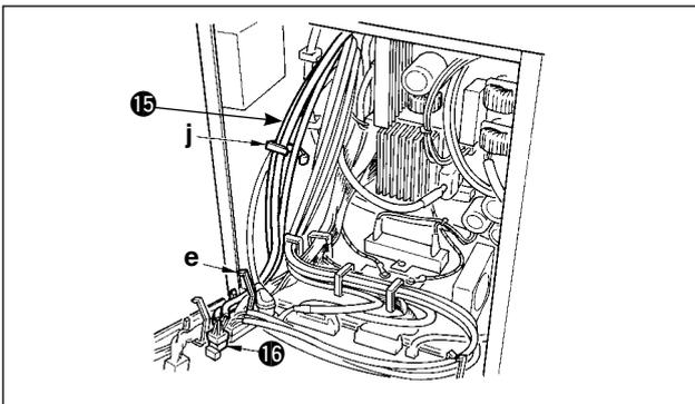
12) Introduire le cordon du connecteur blanc à 6 broches 15 provenant de la tête de la machine dans la boîte électrique par l'orifice du couvercle avant B, le faire passer par les attache-câbles "e" et "j" et le brancher au connecteur CN54 16.
