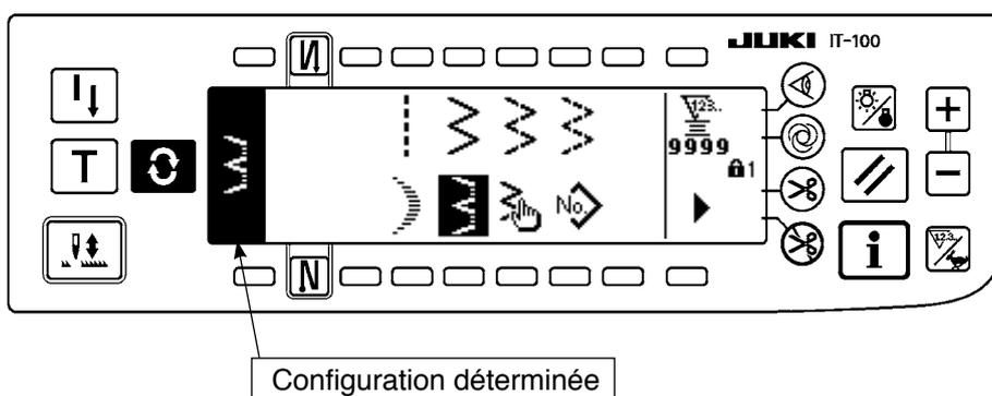
2) Par exemple, appuyer sur la touche de point invisible gauche ⑥. L'écran représenté à gauche apparaît pour la détermination de la configuration.
