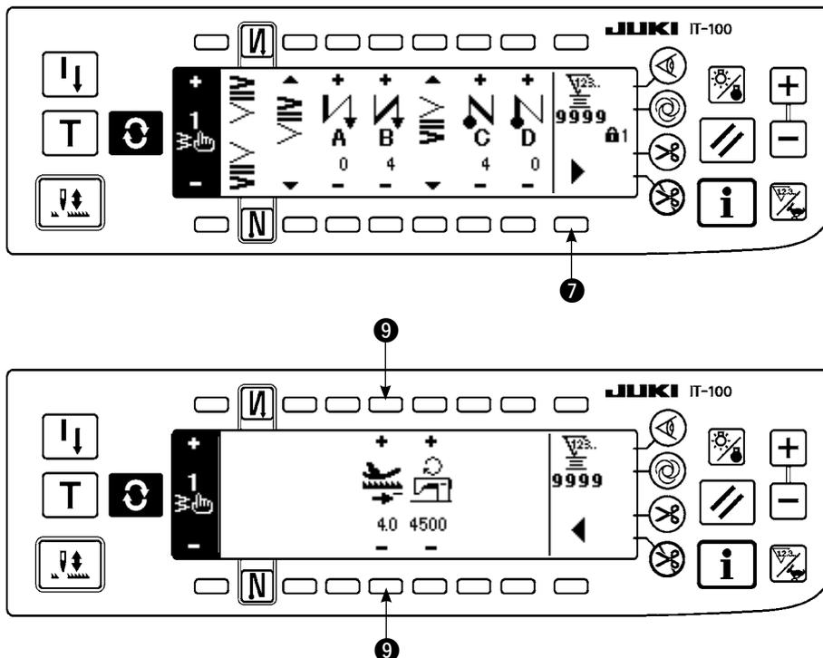
⑨ : Permet de spécifier le pas d'entraînement lors de l'exécution automatique de points arrière ou de l'utilisation de l'interrupteur manuel. Lorsqu'on appuie sur le levier de commande d'entraînement arrière pendant la couture, le pas d'entraînement change continuellement du pas d'entraînement spécifié à l'écran de paramétrage de la configuration au pas d'entraînement arrière spécifié ici.
