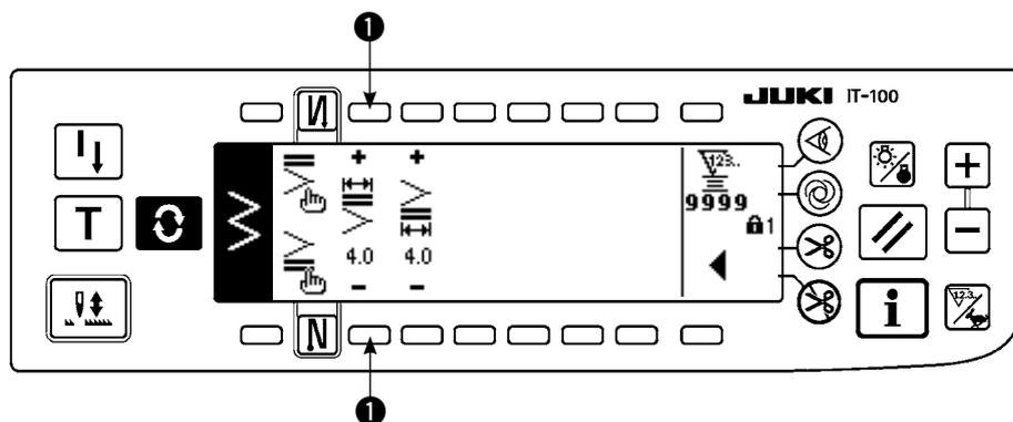
Le second écran de paramétrage d'exécution de points arrière est expliqué en prenant pour exemple la saisie d'une configuration de condensation personnalisée au début de la couture (largeur de 4 mm pour des points zigzag à 2 étapes).
