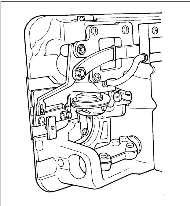
Si des fragments de tissu ou autres s'accumulent ou adhèrent dans la partie du crochet, ceci peut provoquer des dysfonctionnements (défauts de couture, grippage du crochet, etc.). Nettoyer périodiquement cette partie.
