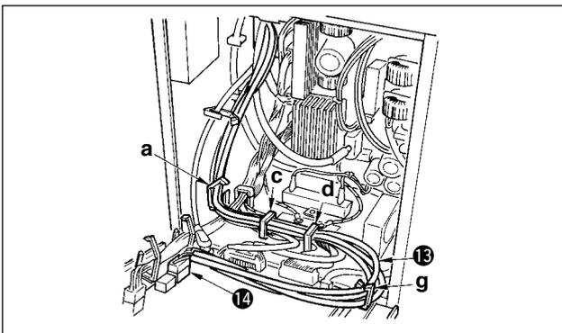
11) Introduire le cordon du connecteur blanc à 12 broches 13 provenant de la tête de la machine dans la boîte électrique par l'orifice du couvercle avant B, le faire passer dans les attache-câbles "a", "c", "d" et "g", puis l'introduire dans le connecteur CN53 14. Fermer les attache-câbles "a", "c" et "d".
