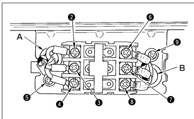
1) Desserrer la vis ❶ située sur le côté de l'interrupteur d'alimentation fourni comme accessoire et retirer le couvercle de l'interrupteur d'alimentation.
