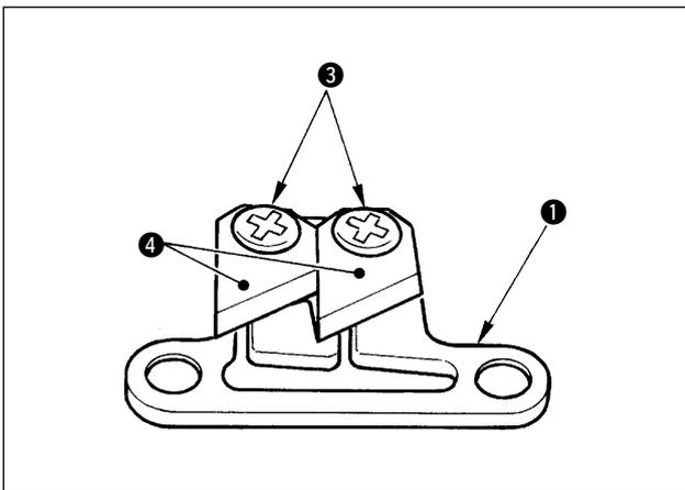
2) Oter les deux vis **3** du couteau **4** (céramique) à l'aide d'un tournevis de précision et retirer le couteau de la plaque de fixation **1**. Remplacer ensuite le couteau.
