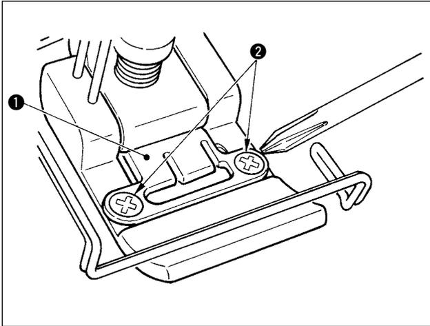
1) Oter les deux vis **2** de la plaque de fixation du couteau **1** à l'aide d'un tournevis de précision et retirer la plaque.
