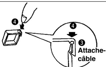
④ Appuyer légèrement sur le coin de l'attache-câble.
