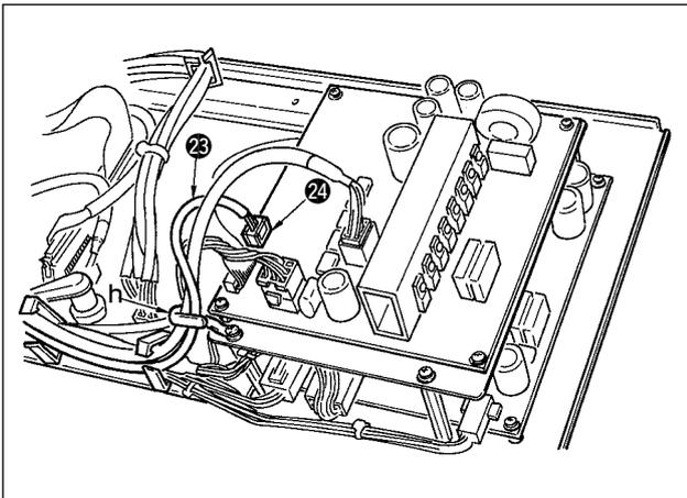
15) Introduire le cordon du connecteur noir à 4 broches 23 provenant de la tête de la machine dans la boîte électrique par l'orifice du couvercle avant B, le faire passer dans les attache-câbles "e", "f", "h" et "j", puis le brancher au connecteur CN73 24.
