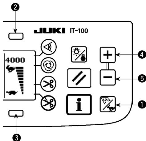
Appuyer sur le commutateur compteur/changement de vitesse ❶ pour basculer sur l'écran de réglage de la vitesse de couture maximale. Appuyer sur le bouton ❷ ou ❹ pour augmenter la vitesse de couture ou sur le bouton ❸ ou ❺ pour la diminuer. (par pas de 50 sti/min)
