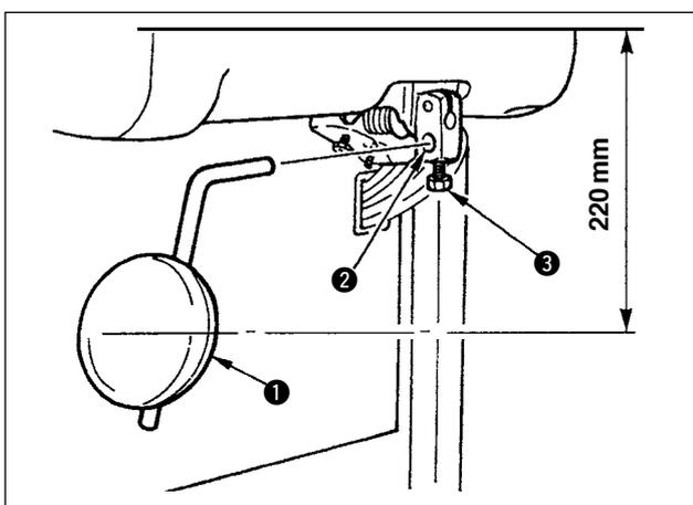
Introduire la genouillère dans l'orifice de fixation ❷ et la serrer avec le boulon ❸.
