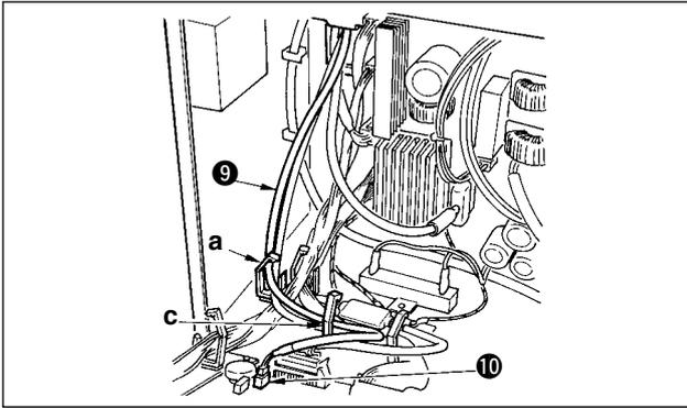
9) Introduire le cordon blanc à connecteur noir à 4 broches 9 provenant de la tête de la machine dans la boîte électrique par l'orifice du couvercle avant B et le brancher au connecteur CN31 10 à travers les attache-câbles a et c.
