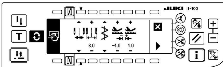
3) La figure de gauche représente le mode de largeur de zigzag symétrique par rapport au centre. A chaque pression sur la touche ❸, on passe alternativement entre la définition des positions gauche/droite et de la largeur de zigzag symétrique par rapport au centre.
