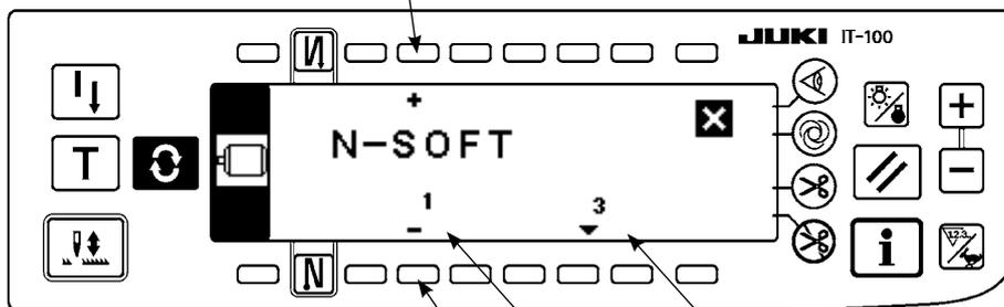
4) Cet écran est l'écran de paramétrage des fonctions. Changer le numéro de paramètre avec la touche "+/-" de l'interrupteur **3**.
