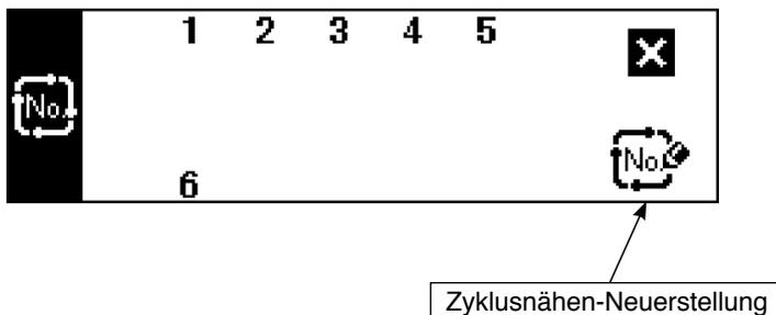
Die Tastensperrenstufe wurde werksseitig auf "1" eingestellt, und Piktogramme von Neuerstellungen werden nicht angezeigt. Wenn Sie eine Neuerstellung im jeweiligen Modus durchführen, ändern Sie die Tastensperrenstufe auf "0". (Siehe den zweiten Bildschirm der Allgemein-Nähdateneinstellung unter (1) Allgemein-Nähdaten von 6-16. Information.)
