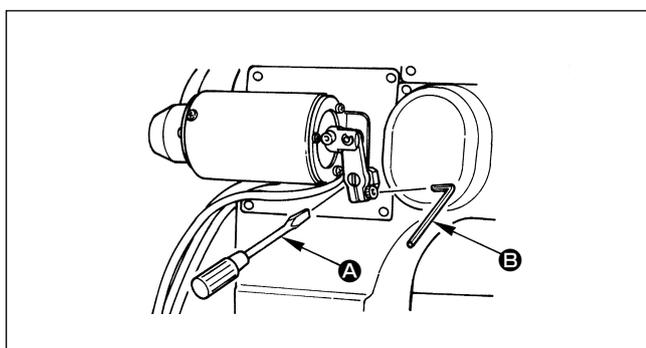
Поворачивая соленоидный вал при помощи приводного механизма A, затяните зажимной болт при помощи шестигранного ключа гайковерта B.
