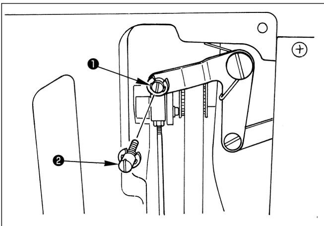
1. Удалите заднюю крышку головки машины и замените шарнирный винт соединительного штока коленоподъемника **1** прилагаемым пальцем тяги коленоподъемника **2**.
