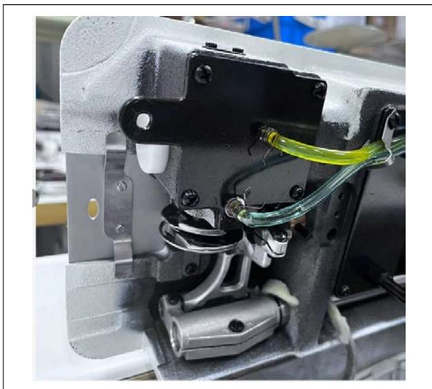
Si des fragments de tissu ou autres s'accumulent ou adhèrent dans la partie du crochet, ceci peut provoquer des dysfonctionnements (défauts de couture, grippage du crochet, etc.). Nettoyer périodiquement cette partie.
