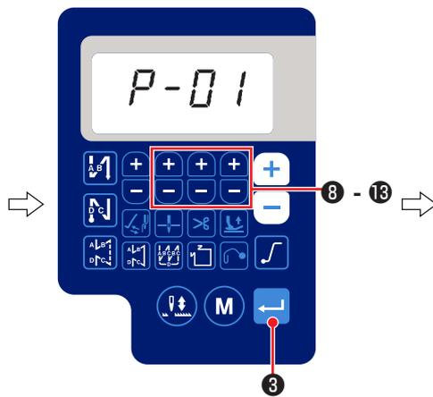
Pulse las teclas **+** , **-** ⑧ a ⑬ para seleccionar el código de parámetro P01. Luego, pulse **←** ③ para ingresar los [Datos de ajuste de función].
