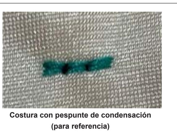
\* Se puede utilizar la función de puntada superpuesta para la finalidad de pespunte de condensación realizando el ajuste a continuación.
