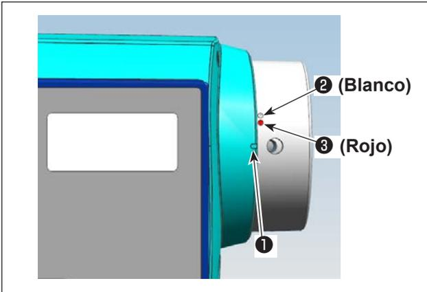
La posición de parada superior de la barra de aguja se obtiene alineando el punto demarcador ① en la cubierta con el punto demarcador blanco ② en el volante.
