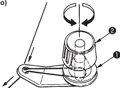
1. Cuando bobine hilo de bobina, comience el bobinado en el estado que quede tenso el hilo entre la bobina y el disco ① tensor de hilo.
