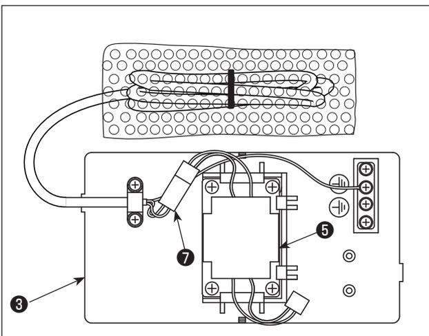
3) Conecte el conector ⑦ del cable de corriente eléctrica que está fijado al conjunto de la base del reactor ③ al conector del reactor ⑤ .
