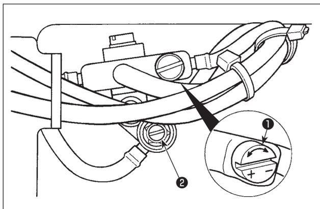
Incline el cabezal de la máquina, y ajuste la cantidad de aceite en el gancho girando el tornillo de ajuste
