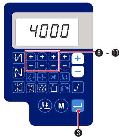
① Pulse **+** , **-** ⑥ a ⑪ para ajustar la Velocidad Máxima de Cosido.
