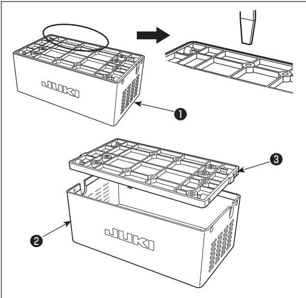
1. Extraiga la cubierta del reactor ② de la caja del reactor ① para separarla del conjunto de la base del reactor ③ .
