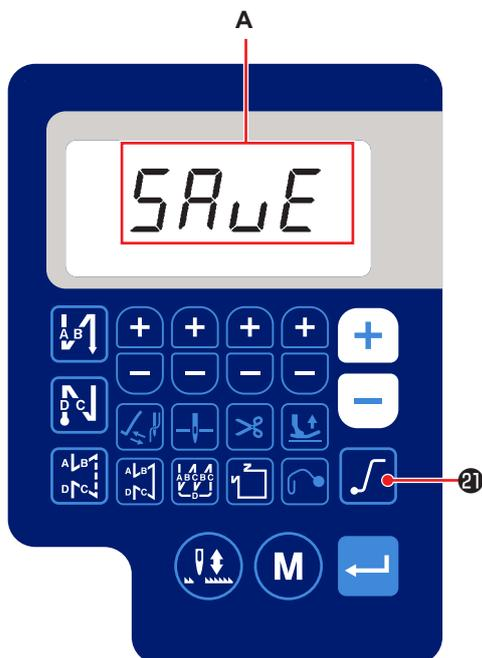
3) Al mantener pulsado
