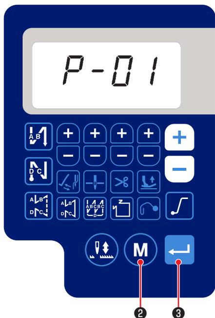
1) Pulse **M** <sup>2</sup> en el estado de cosido normal para visualizar la pantalla de ajuste de función. Consulte la explicación dada en "**VI-4. Ajuste de funciones**" p.38 y, a continuación, seleccione el número de ajuste de función que desea almacenar y pulse
