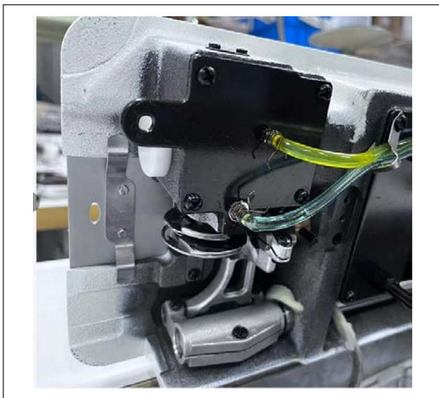
Cuando se acumulen desperdicios de tela o semejantes o se adhieran alrededor de la sección del gancho, se producirán problemas como (cosido defectuoso, agarrotamiento del gancho, etc.) en la máquina de coser. Limpie la sección periódicamente.
