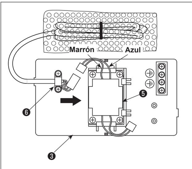
2) Deslice el reactor ⑤ en la dirección de la flecha para insertar en el conjunto de la base del reactor ③ .
