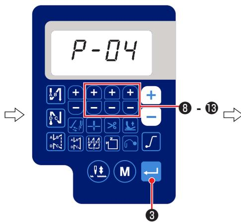
Pulse las teclas **+** , **-** ⑧ a ⑬ para seleccionar el código de parámetro P04. Luego, pulse **←** ③ para ingresar los [Datos de ajuste de función].
