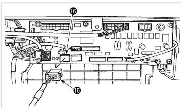
5) Il connettore per il pannello operativo è in dotazione con l'unità.
