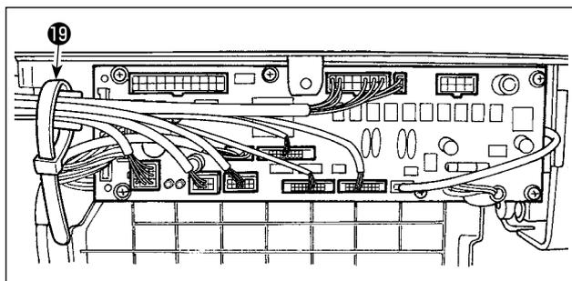
7) Dopo aver inserito il connettore, mettere tutti i fili insieme con il nastro fermacavi **19** posto sul lato della centralina.
