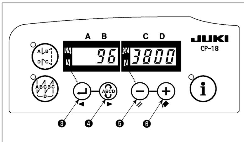
3) Dopo aver selezionato il tipo di testa della macchina, premendo l'interruttore **(←)** 3 (l'interruttore **(ABCD)** 4), il passo procede a 94 o 96, e l'indicazione cambia automaticamente al contenuto dell'impostazione corrispondente al tipo di testa della macchina.
