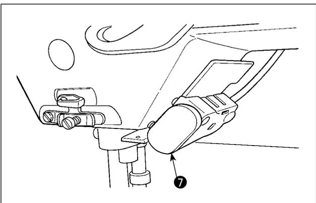
7) Per alcuni tipi di teste della macchina per cucire, il trasporto inverso viene eseguito premendo il pulsante per affrancatura **7**.
