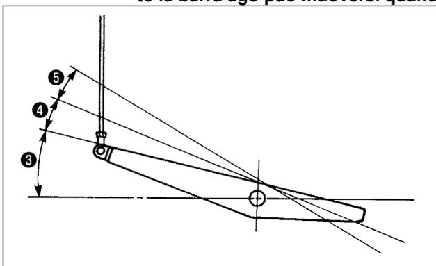
3) Quando la parte anteriore **3** del pedale viene premuta, la macchina gira al numero di giri a seconda della quantità di pedaleggio.
