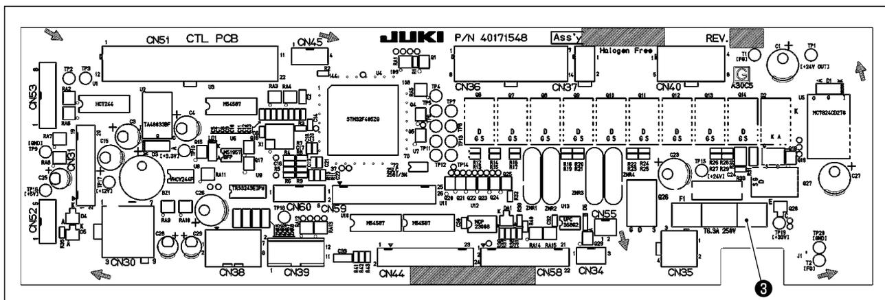
**(Attenzione)** Vi è il rischio di scosse elettriche durante la rimozione del fusibile. Assicurarsi di rimuovere il fusibile dopo che il LED ② si è completamente spento.
