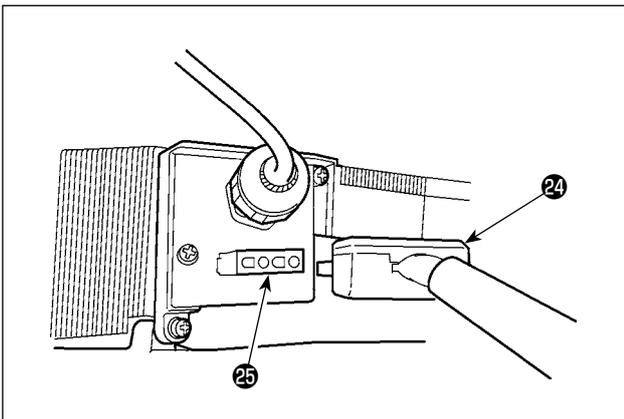
Collegare il cavo dell'uscita del motore ②④ al connettore ②⑤ posto sulla parte laterale della centralina.
