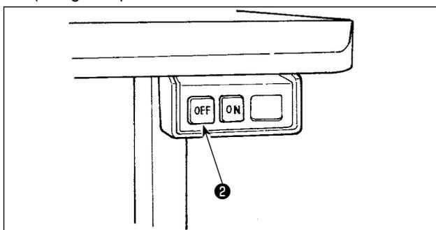
8) Quando la cucitura è completata, premere il bottone OFF **2** dell'interruttore dell'alimentazione per spegnere l'interruttore dell'alimentazione dopo essersi assicurati che la macchina per cucire è ferma.
