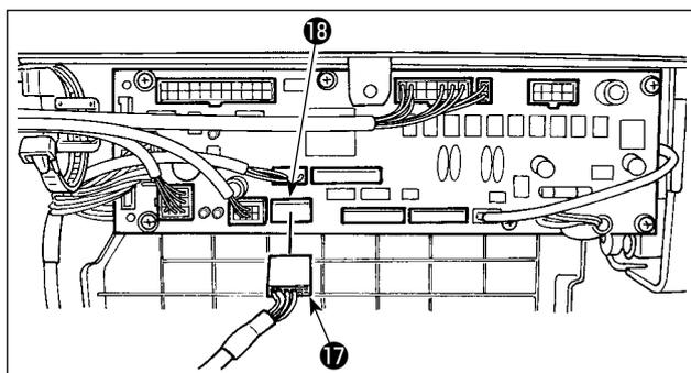
6) Per utilizzare l'unità pedale con la macchina per cucire per lavoro in piedi, inserire il connettore PK70 **17** nel connettore **18** (CN39: 12P) sulla scheda a circuito stampato.
