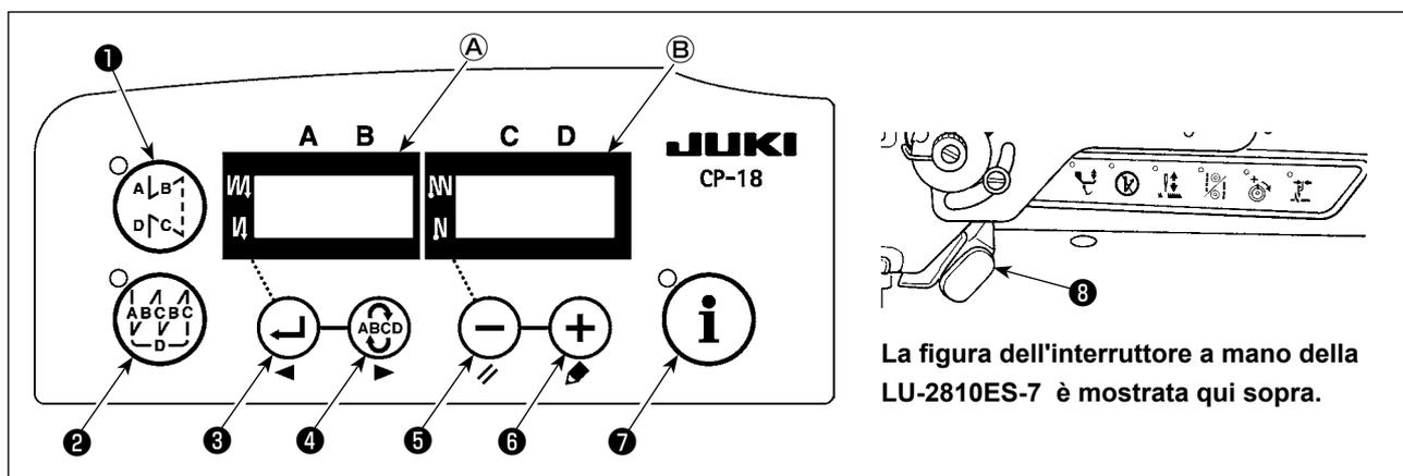
Per la testa della macchina per cucire che è dotata dell'interruttore a mano o interruttore a ginocchiera, la funzione di ingresso/uscita dell'interruttore può essere impostata premendo l'interruttore durante l'operazione di impostazione della funzione.
