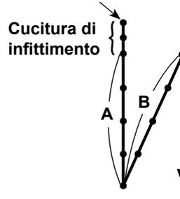
Nel caso in cui la funzione di affrancatura per l'inizio della cucitura sia abilitata, le posizioni di inizio e fine della cucitura non sono allineate l'una all'altra se il valore di impostazione è 1 (Valore di impostazione: 1).
