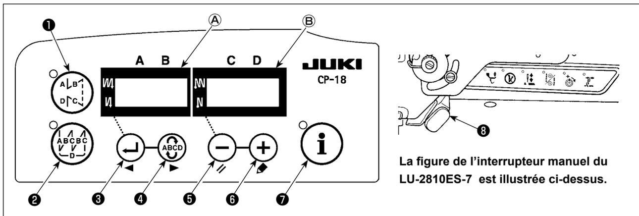
Pour la tête de machine à coudre fournie avec l'interrupteur manuel ou la genouillère, l'activation/désactivation de l'interrupteur peut être sélectionnée en appuyant sur l'interrupteur pendant le paramétrage avec touche unique.
