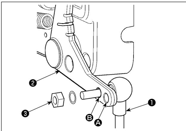
1) Fixer la tige d'accouplement 1 à l'orifice B du levier de pédale 2 avec l'écrou 3.
