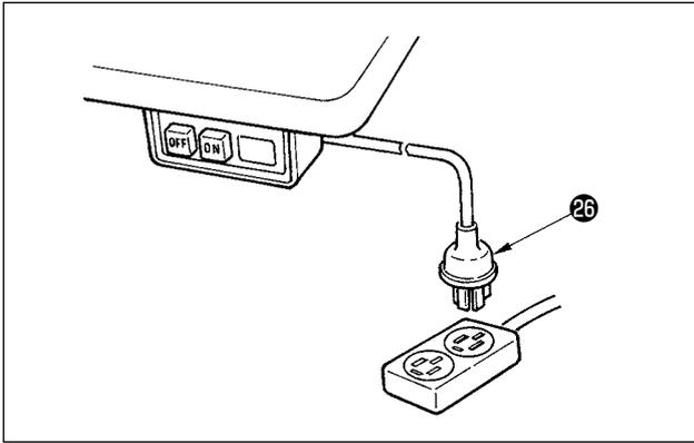
11) S'assurer que l'interrupteur d'alimentation est sur arrêt (OFF), puis brancher le cordon d'alimentation 26 provenant de l'interrupteur d'alimentation à la prise de courant .
