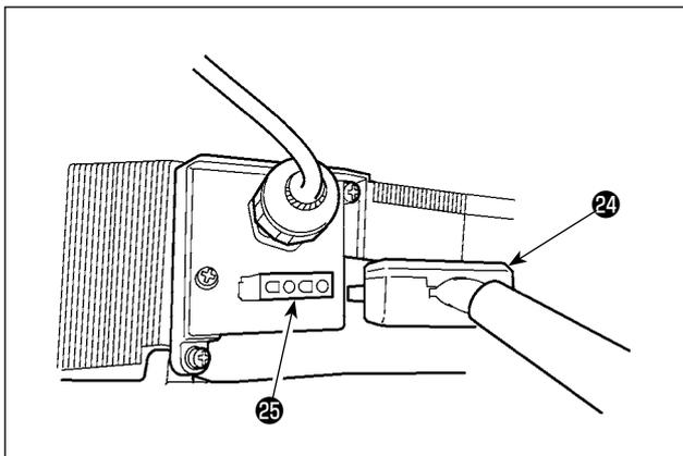
Brancher le cordon de sortie du moteur ②④ au connecteur ②⑤ situé sur le côté de la boîte.
