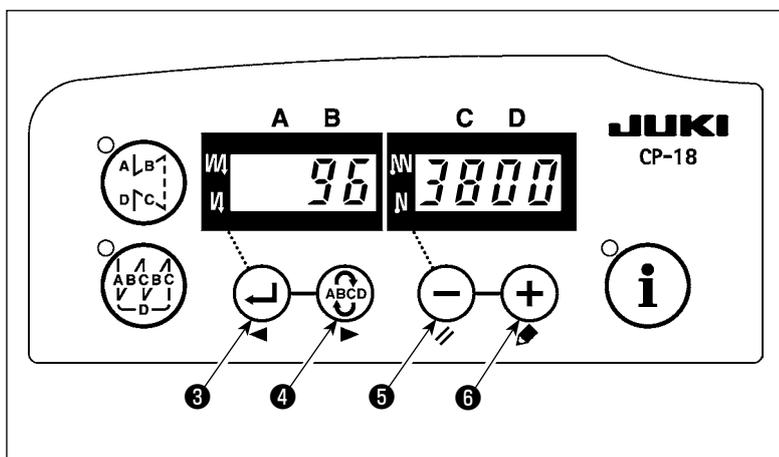
3) Lorsqu'on sélectionne le type de tête de machine avec la touche **(← 3)** (touche **(ABCD 4)**), on passe à l'étape 94 ou 96 et le contenu du paramètre correspondant au type de tête de machine s'affiche.
