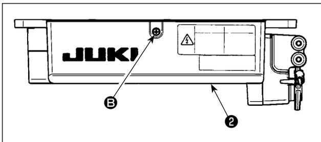
8) Fermer le couvercle ③ et le fixer en serrant la vis ⑤ avec un tournevis.
