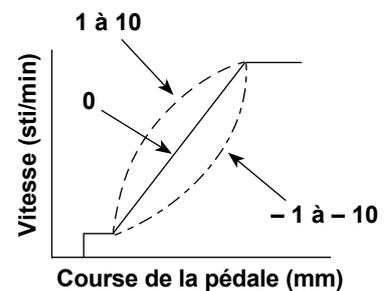
②① **Fonction de déplacement en position d'arrêt HAUTE du mouvement initial (paramètre n° 90)**
