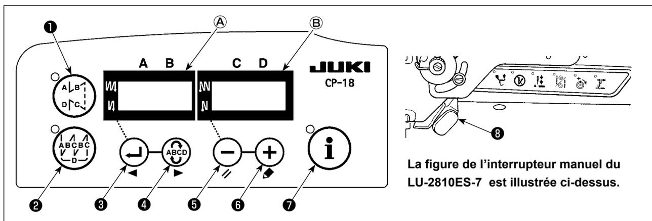
Pour la tête de machine à coudre fournie avec l'interrupteur manuel ou la genouillère, la fonction d'entrée/sortie de l'interrupteur peut être réglée en appuyant sur l'interrupteur pendant le réglage des fonctions.
