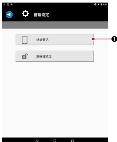
1) 让缝纫机一侧的面板处于终端登录等待状态。(操作方法参考各个面板的服务手册)
