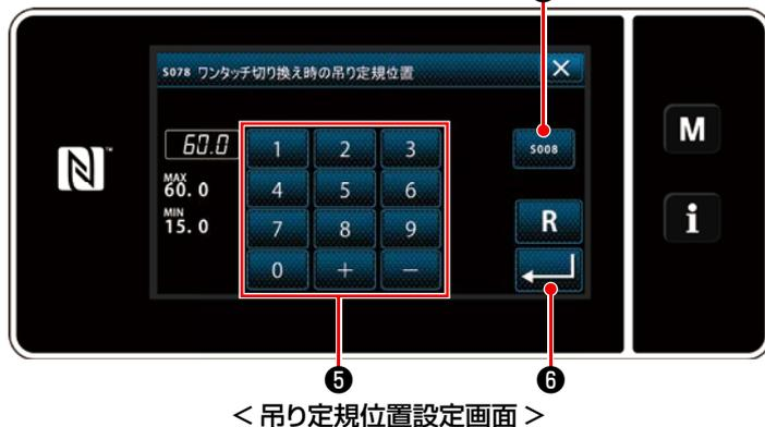
ワンタッチスイッチを押すと、入力した位置に吊り定規が移動し、再度押すと解除されます。
