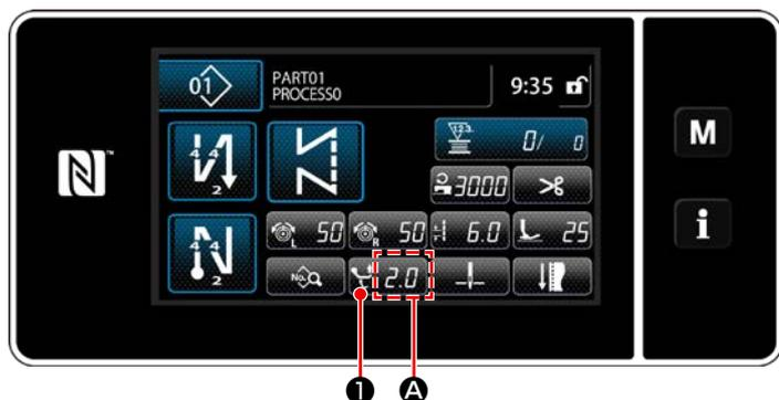
La quantità di movimento verticale alternato viene visualizzata nella sezione **A** sul pannello operativo. (Esempio di visualizzazione : 2,0 mm)
