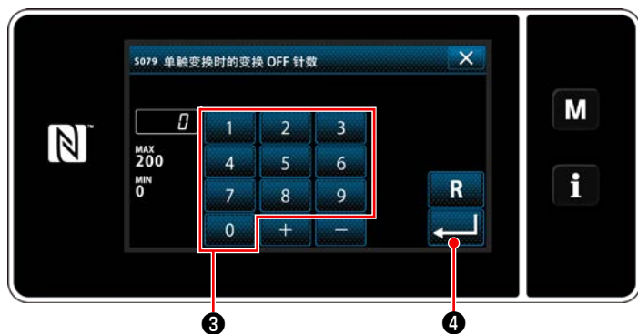
＜一键式切换时的切换 OFF 针数画面＞
