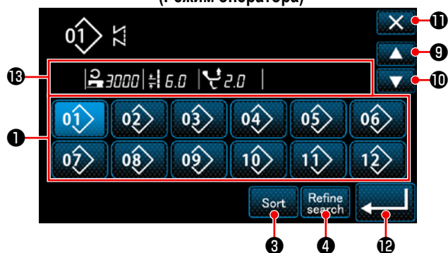
Окно перечня шаблонов: в числовом порядке (Режим оператора)
