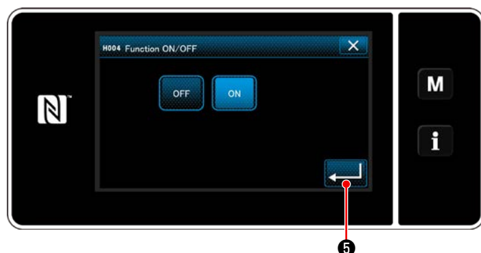
<Экран настройки включения/ отключения функции обнаружения величины остатка шпульной нити>
