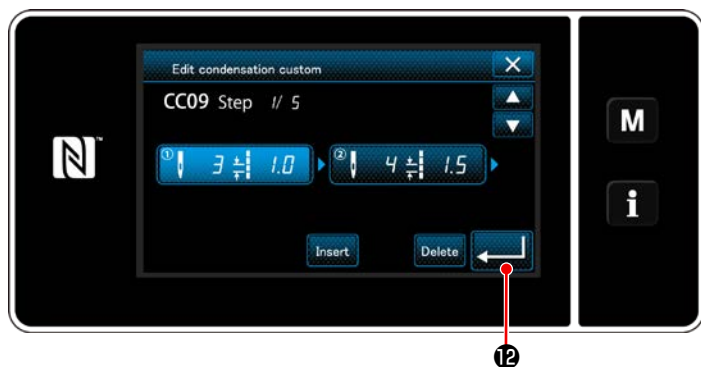
<Окно редактирования пользовательской настройки плотной строчки>
