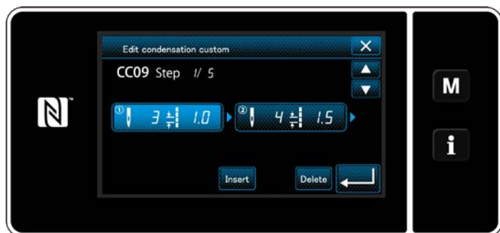
<Окно редактирования пользовательской настройки плотной строчки>
