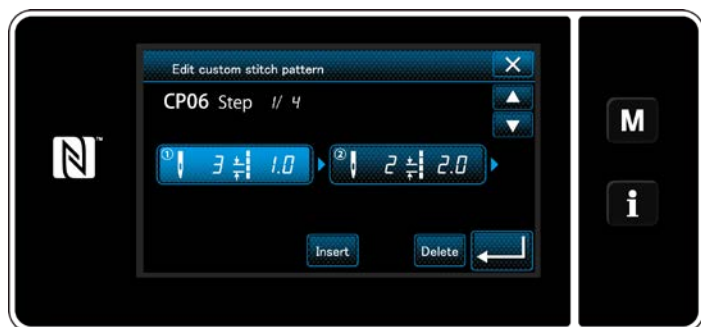
<Schermata di editaggio del passo personalizzato>
