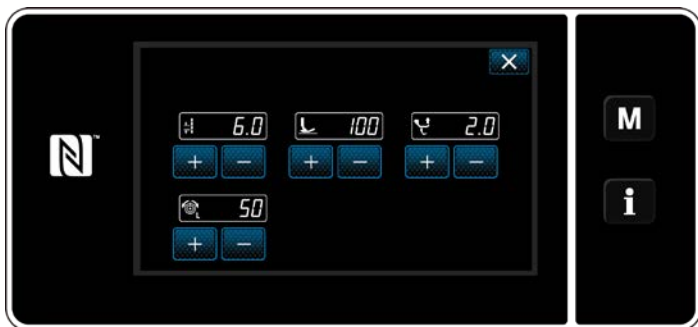
<Schermata di modalità di regolazione della cucitura>
