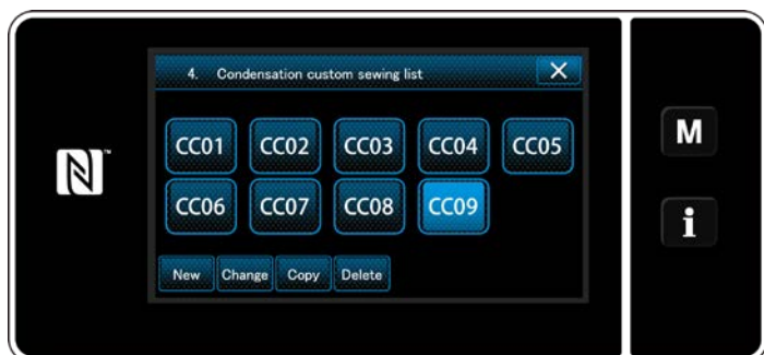
<Schermata di elenco dei modelli di cucitura dell'infittimento personalizzato>
