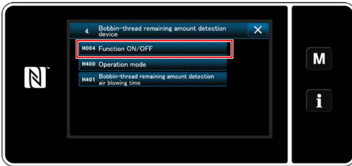
<Pantalla de ajuste del dispositivo detector de cantidad remanente de hilo de bobina>
