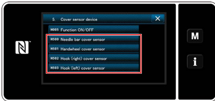
<Einstellbildschirm für Abdeckungssensorvorrichtung>
