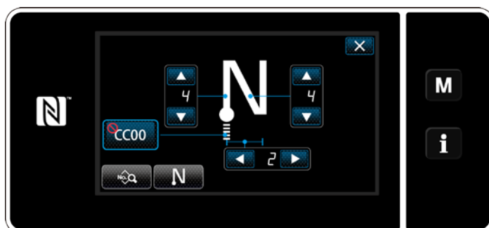
<Bearbeitungsbildschirm für Rückwärtsnähen am Nahtende>
