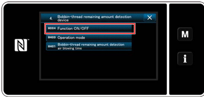
<Einstellbildschirm für Spulenfadenrestbetrag-Erkennungsvorrichtung>
