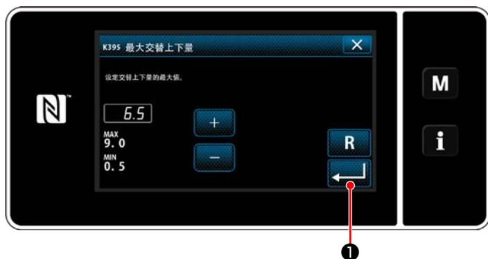
在面板上的 A 部分显示交替上下量。
