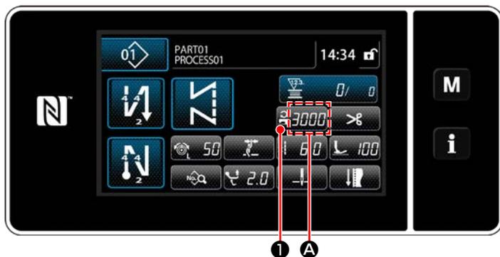
缝制速度显示在操作盘上的 **A** 部。
