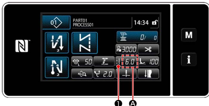
缝迹长度显示在操作盘上的 **A**。（图示例：6.0mm）
