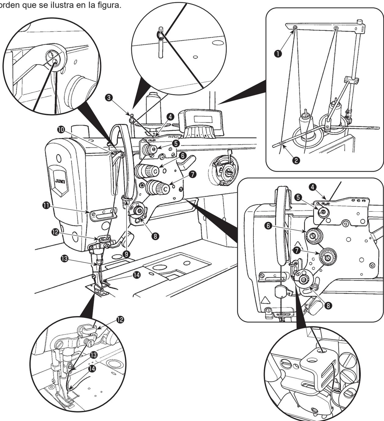
1. El guahilos 12 es necesario para evitar que el hilo se salga del ojo de la aguja al ejecutar el corte de hilo en una posici3n fuera del material.
