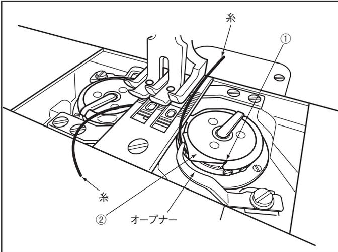
(2) 左手で2本の上糸をつまみ、右手でプーリをゆっくり一回転させ、図のように上糸を引き上げると下糸も出てきます。上糸下糸はそろえて押えの下から向こう側へ出しておきます。
