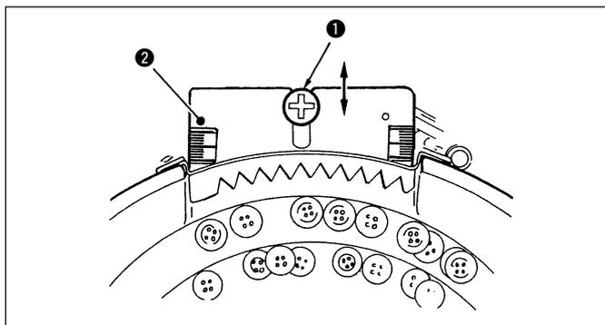
Bottoni con il loro rovescio in su vengono messi da parte da quelli con il loro dritto in su quando passano attraverso la piastra di selezione. Quindi, soltanto i bottoni con il loro dritto in su vengono alimentati nell'unità di indice. Per regolare la piastra di selezione, allentare vite **1**, e spostare piastra di selezione **2** in avanti e indietro fino a che la stessa non venga posizionata correttamente. Stringere quindi vite **1**.
