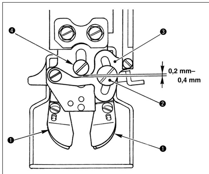
Con la macchina in posizione di stop, sollevare le ganasce della pinza bottoni ❶. Allentare quindi vite ❷ nella pinza bottoni e regolare in modo che un gioco compreso tra 0,2 e 0,4 mm sia lasciato tra leva di blocco ❸ della pinza bottoni e vite perno ❹ quando si posiziona un bottone nelle ganasce della pinza bottoni ❶.
