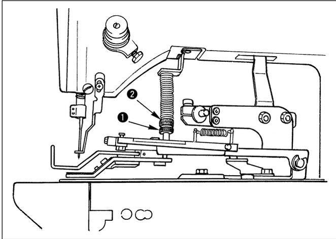
La pressione dell'unità di premistoffa dovrebbe essere minimizzata purché il materiale non si curvi durante la cucitura. Allentare vite di regolazione ❶ e girare vite di regolazione ❷ per ottenere la pressione sopraccitata.
