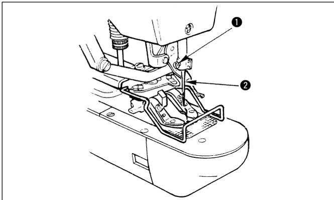
Per montare l'ago, allentare vite ❶, inserire ago ❷ completamente nel foro della barra ago con la scanalatura lunga volta verso l'operatore, stringere quindi vite ❶.
