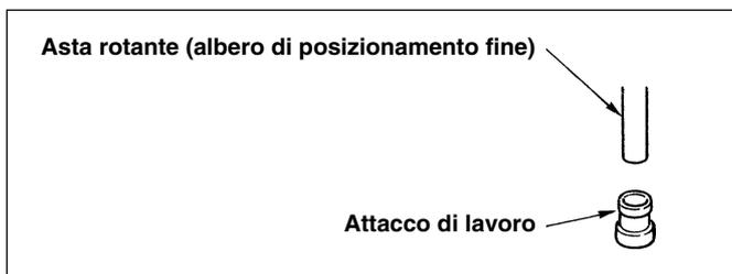
Rimuovere l'attacco di lavoro attualmente montato sulla macchina per cucire dall'asta rotante. Montare quindi l'attacco di lavoro di un altro tipo sulla macchina. A questo punto, assicurarsi di controllare che l'attacco di lavoro sia messo a posto in modo sicuro.
