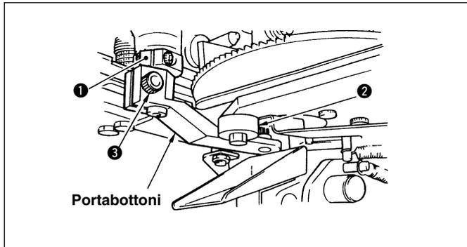
Per sostituire il portabottoni, allentare vite ③, rimuovere quindi il portabottoni. Sostituire il portabottoni con uno che abbia un interasse opportuno, adattarlo a camma eccentrica ②, e simultaneamente posizionarlo in modo che la sua faccia superiore venga in contatto con dado ①. Fissare quindi il portabottoni con vite ③.
