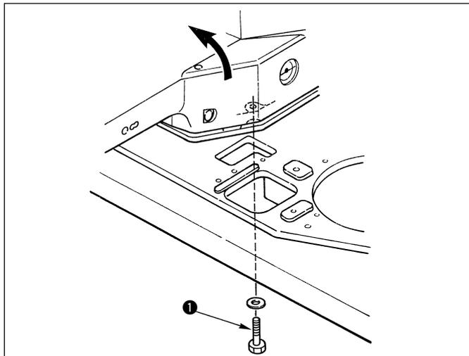
Rimuovere vite ❶, e inclinare lentamente la testa della macchina in senso della freccia.
