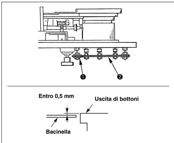
Allentare sei dadi di bloccaggio ❶ in base di alimentazione ❷, e regolare l'altezza in modo che la vaschetta di alimentazione venga sopra quando la differenza in livello tra l'uscita di bottoni della vaschetta di alimentazione e la bacinella è entro 0,5 mm. Se la differenza in livello è eccessiva, due bottoni entrano ammassati nell'piastra di trasporto. Perciò, fare attenzione.
