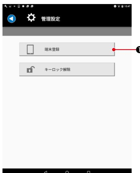
1) ミシン側のパネルを端末登録待ち状態にします。(操作方法は各パネルのサービスマニュアル参照)
