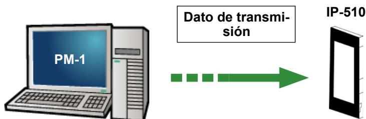
Conecte la PC y el IP-510 con un cable USB, cree datos en PM-1, y luego envíe los datos a la máquina de coser. Al conectar el IP-510 mediante un cable USB, la pantalla de cosido de prueba se mostrará automáticamente. Para obtener detalles sobre cómo operar el PM-1, consulte la ayuda de PM-1 o recursos similares.
