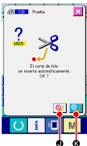
En el caso en que no exista comando de corte de hilo en la terminación de patrón antes del trasporte de salto, la pantalla de confirmación de inserción de corte de hilo se visualiza después de presionar el botón SEWING PREPARATION
