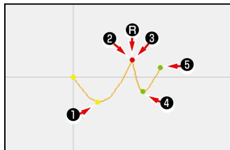
Cuando ejecute el borrado de punto de configuración de cualquiera de los puntos posterior **2** y frontal **3**, el punto de interrupción deviene punto de paso normal y se forma el cosido estriado continuo.
