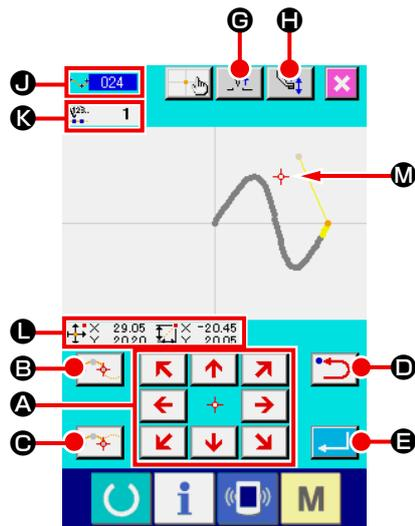
La figura en el lado derecho es la pantalla que especifica la posición que se visualiza cuando se especifica la posición al hacer la fijación de función. El código seleccionado de la función se exhibe en **J**.
