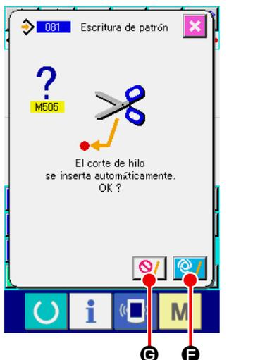
En el caso de que no exista el comando de corte de hilo en la terminación del patrón y antes del transporte de salto, se visualiza la pantalla de confirmación de inserción de corte automático de hilo después de presionar el botón ENTER
