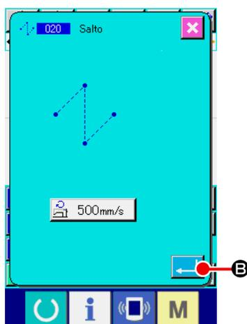
Presione el botón ENTER
