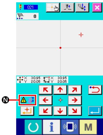
En **N** el pictógrafo de aviso
