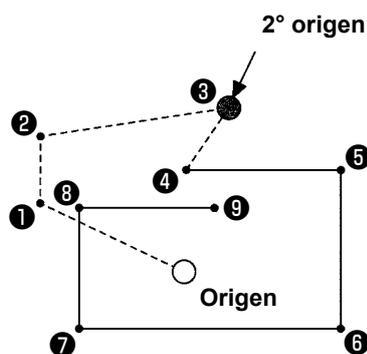
Cuando el 2° origen se fija en ③ de la sección de transporte de salto en la figura del lado izquierdo, el transporte se detiene en ③ después del transporte de salto de ① → ② → ③, y entonces la máquina de coser ejecuta la operación cíclica del ③ al ⑨.
