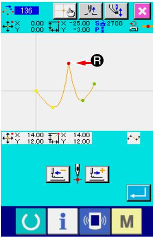
Cuando usted quiera mover el punto **R** a punto **S**, el resultado cambiará seleccionando ya sea el punto de configuración posterior **2** o frontal **3**.
