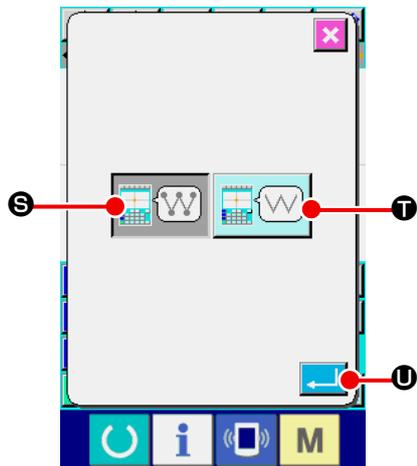
⑥ **Para ejecutar la fijación de la visualización del punto de entrada de aguja**
