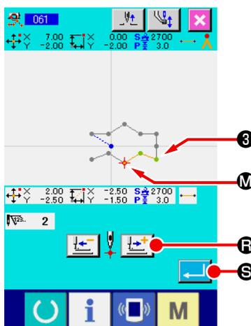
Presione el botón FEED FORWARD
