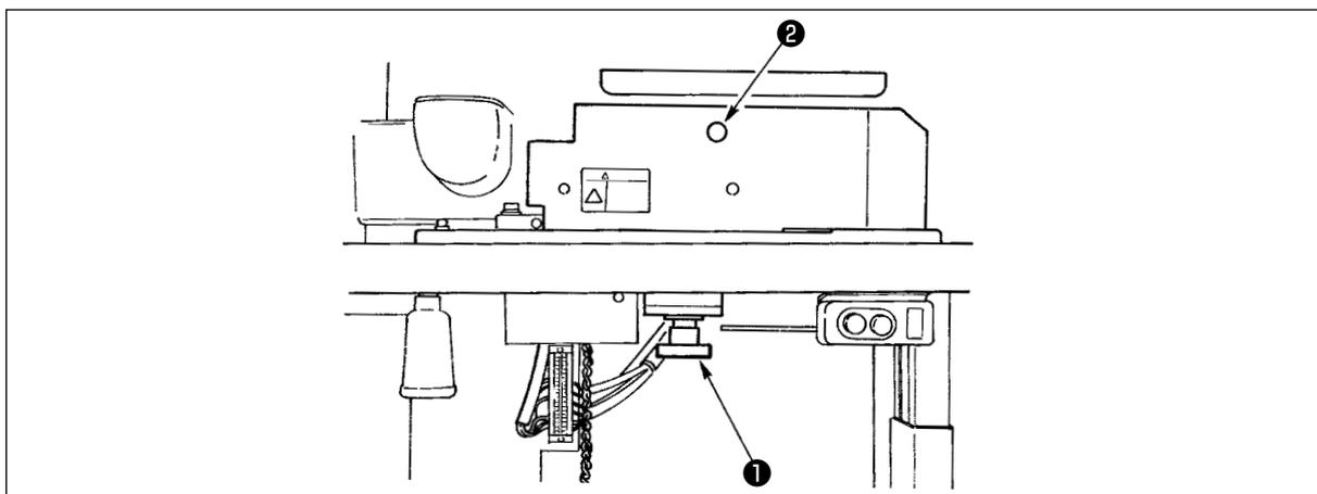
8. Когда сообщается об ошибке "4" с указанием на события отказа качающегося рычага аппарата намотки или об ошибке "5" с указанием на событие сбоя блока делительного устройства, переключатель сброса не будет действовать, чтобы защитить механические компоненты. В этом случае, единожды отключите электропитание машины, а затем заново включите его.
