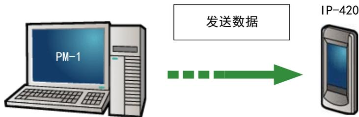
把 IP-420 与电脑连接，用 PM-1 编织数据后向缝纫机传送数据。IP-420 显示出输入画面之后，自动地显示出试缝画面。有关 PM-1 的操作方法，请参阅 PM-1 帮助项目。
