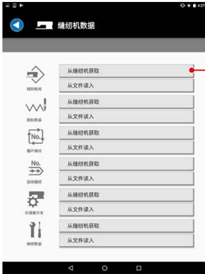
1) 向下按缝制图案的「从缝纫机获取」键①。
