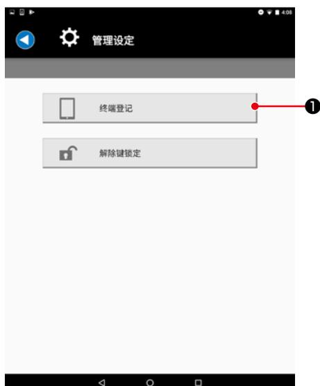
1) 让缝纫机一侧的面板处于终端登录等待状态。(操作方法参照各个面板的服务手册)
