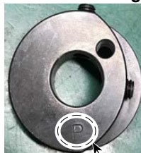
B Leva de corte de hilo derecha antigua
