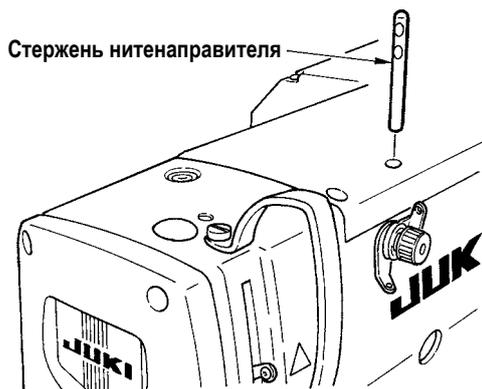
Надежно установите стержень нитенаправителя так, чтобы два боковых отверстия в стержне нитенаправителя смотрели на нитенаправитель.
