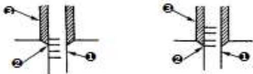
1.用手转动皮带轮，针杆**①**上升时，把下刻线**②**对准针杆下挡块**③**前端
