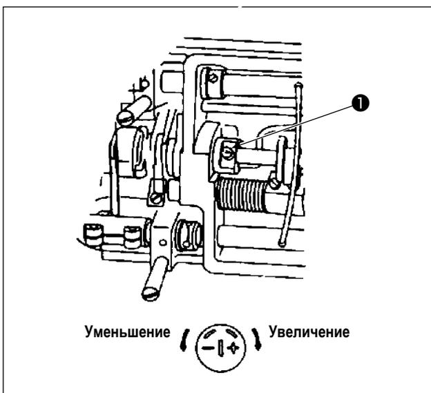
Отрегулируйте количество масла установочным винтом количества масла ❶, который расположен на передней втулке приводного вала челнока. Количество масла увеличивается поворотом установочного винта ❶ по часовой стрелке (+) или уменьшается поворотом его против часовой стрелки (-).
