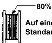
**Auf eine Spule gewickelte Standard-Fadenmenge**
