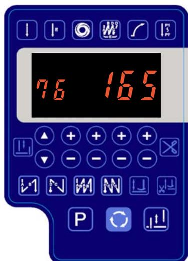
Dans le cas où vous utilisez la machine à coudre en réglant la position d'arrêt de la barre à aiguille sur la position inférieure, il est nécessaire de régler le paramètre de la position d'arrêt de la barre à aiguille.
